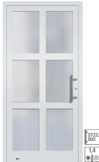
5503 geteilte Sprossen 90 mm, Wärmeschutzisoliertglas, vorne: VSG beschichtet, hinten: Float, alternativ: Mastercarre oder Chinchilla weiß. Oberfläche: RAL 9016 Verkehrsweiß.
