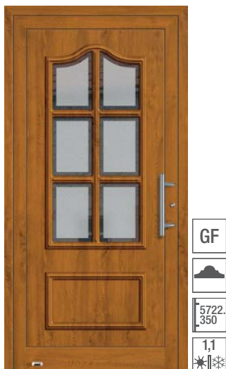
5601 vorne: VSG mattiert mit klarem Rand, hinten: Float beschichtet. Holzdekor Golden Oak, Ornamentrahmen unten innen und außen.
