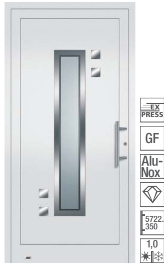
5207 vorne: VSG mattiert mit klarem Rand, hinten: Float beschichtet. Oberfläche: RAL 9016 Verkehrsweiß.
